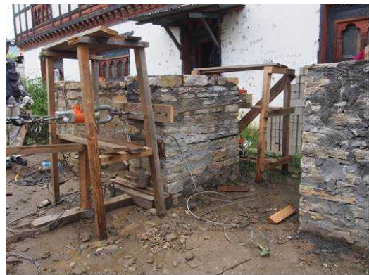
図 4-3：要素試験体の載荷実験
