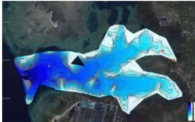
図 2-4 作成した三次元海底地形図 「地図データ：Google、DigitalGlobe」
