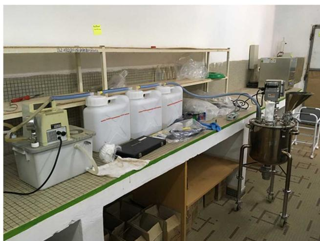
図 1-3 無加圧攪拌装置の実験室での設置状況(カンボワンセ支所)
