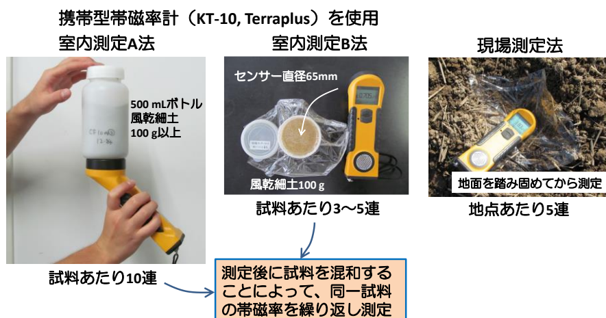
図 3. 室内および現場での帯磁率測定法
