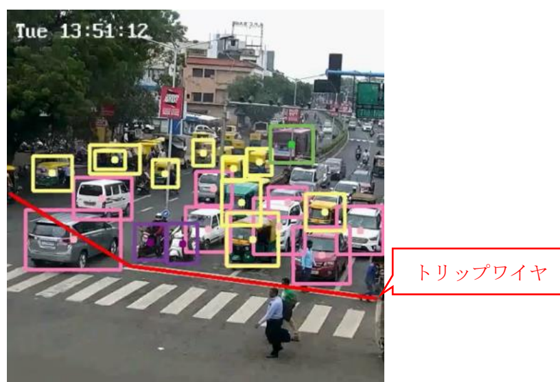
図 2 トリップワイヤを用いた車種別通過台数の計測（アーメダバード・パルディ交差点）
