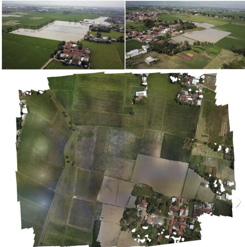
図6-2 2021年3月14日に取得したUAVパノラマ画像と同領域のUAVオルソ画像
