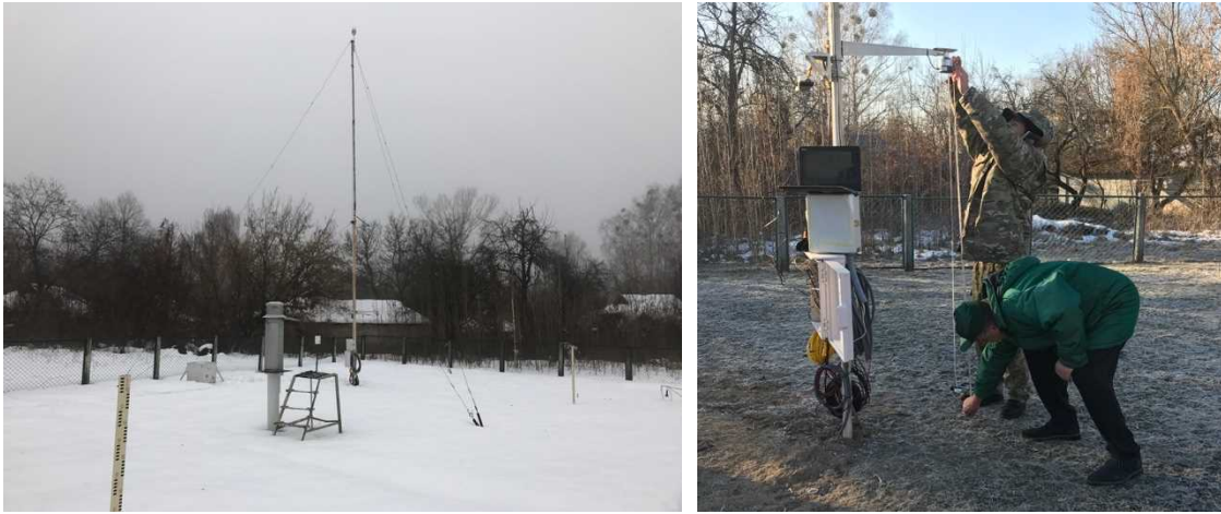
図 4.1 チェルノブイリ規制区域内に設置された気象測器（左）。右は積雪深計の設置高の確認作業。
