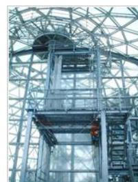
写真 4. 降雨シミュレーター
