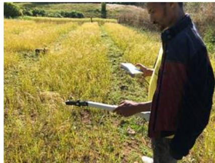
写真12. 受光態勢の測定機器(キャノピーアナライザー)
