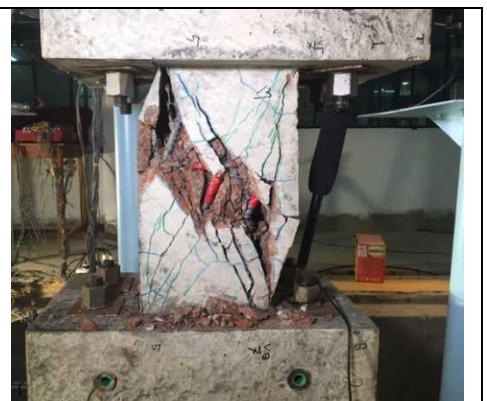
写真10 柱の破壊性状@BUET (2018年7-12月)
