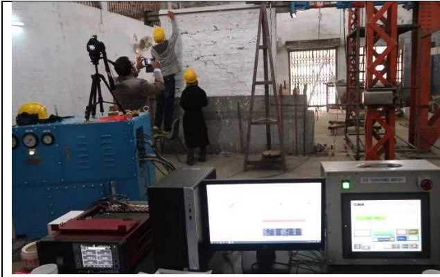
写真2 HBRIでの組積造壁を含む鉄筋コンクリート造架構予備実験（供与機材であるジャッキ・計測機器を使用）（2019年2月）
