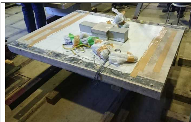
写真 16 袖壁補強を実施したフラットプレート試験体 (2018 年 12 月, 大同大学)
