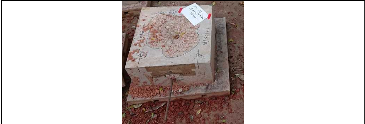
写真 12 BUET でのアンカー引き抜き試験 (2018 年 10-11 月)
