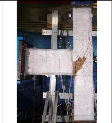
写真 13 梁主筋の抜け出し破壊
