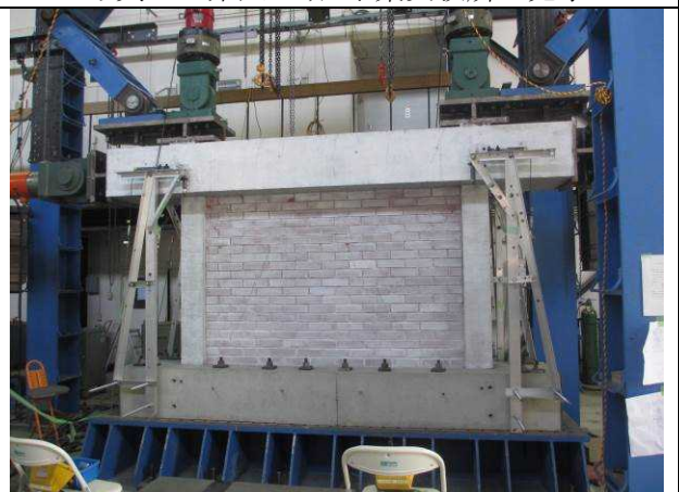
写真 4 東北大学 組積造壁を含む鉄筋コンクリート造架構破壊実験の見学
