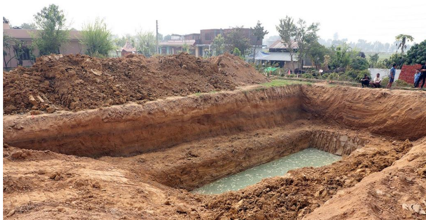
図 8. ブトワル西方ソラウリ地区平成30年トレンチ。幅10 m、長さ25 m、深さ5 m トレンチには、正面の壁面に最新の地震によって南に傾斜した地層が現れ、アバットする地震後の地層に覆われていた。この地層の傾斜は1344年に発生したとみられる。
