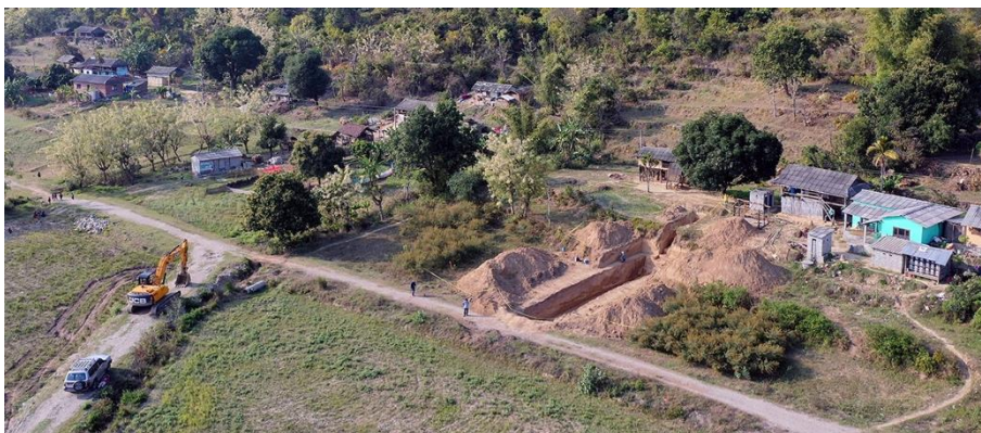
図 9．Gopalkoti-Dandatol 地区トレンチの外観。画面右手の家が立つ細長い丘の手前を道路と平行にのびる斜面が断層崖。
