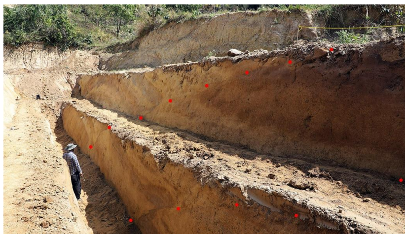
図 10．Dumachaur Khola 地区のトレンチの断面。砂・シルトを主体とし粗粒な礫を含まない最近数千年の堆積物が、赤と黄のドットで示した 2 条の逆断層で大きく変位している。
