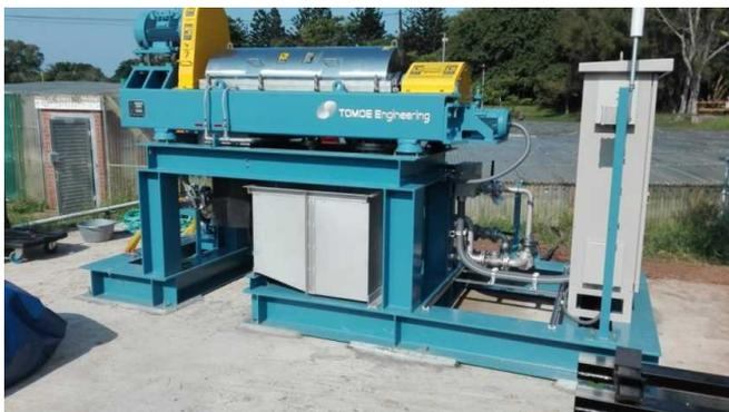
図 4-3 微細藻類回収装置
