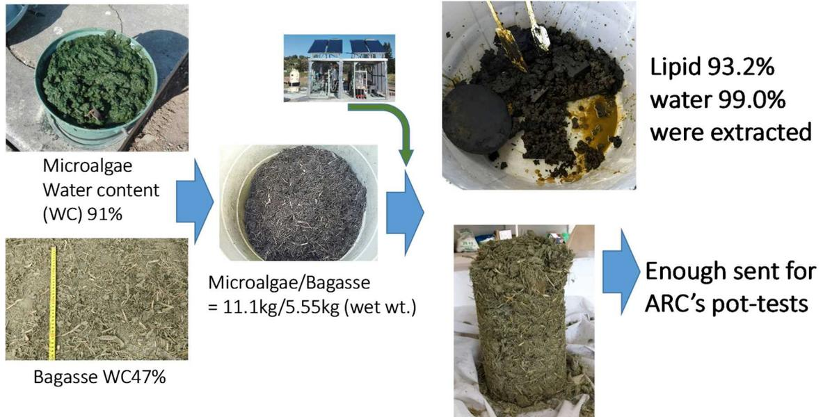
図 4-1 バガスを混合したサンプルの抽出前後の様子
