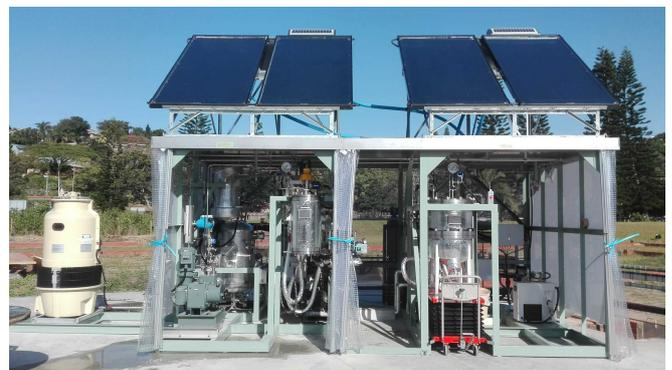
図 4-4 微細藻類油脂抽出装置
