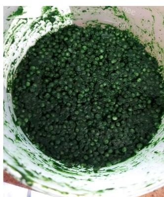
図 4-7 微細藻類とセルロース球の混合サンプル
