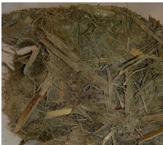
図 2-5 (上) 用いた微細藻類、(中) 微細藻類とバガスの混合物 (混合比 5:2)、(下) 抽出残渣
