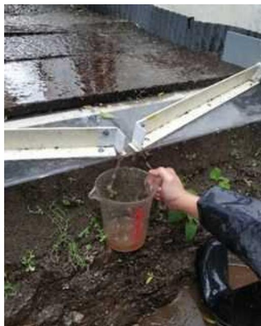
図 3-2-4 流出物回収の様子
