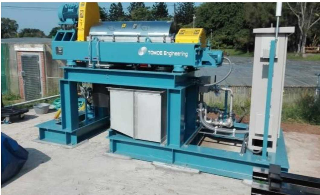
図 2-2 微細藻類回収装置の外観
