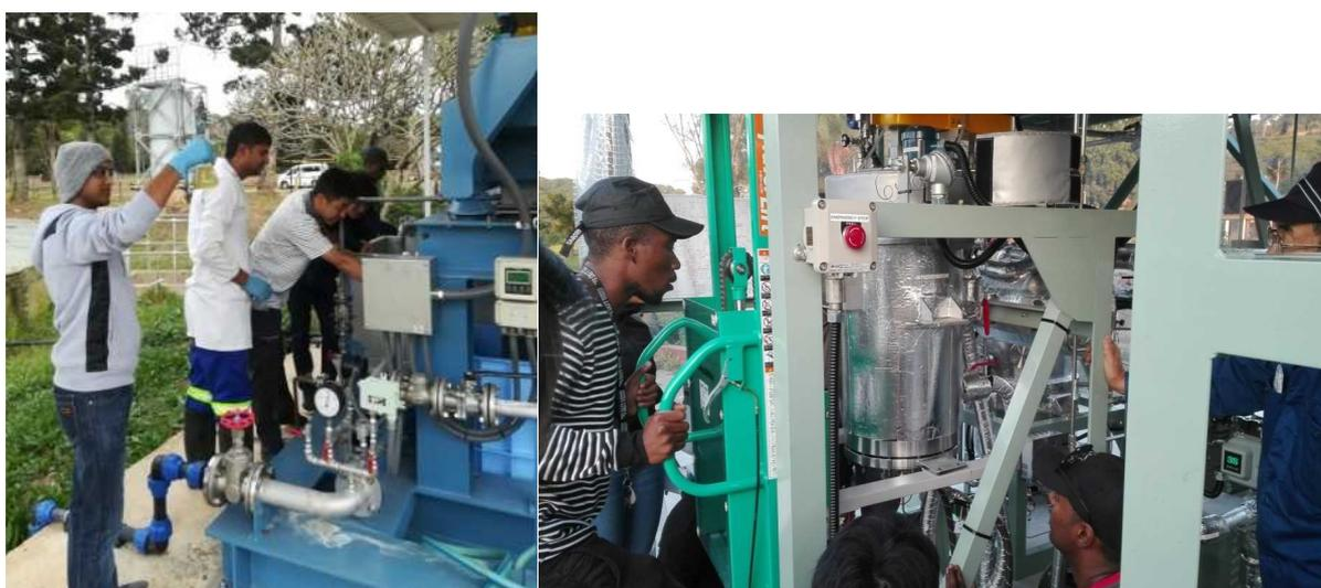
図 2-1 現地での技能訓練の様子（左）微細藻類回収装置、（右）微細藻類油脂抽出装置
