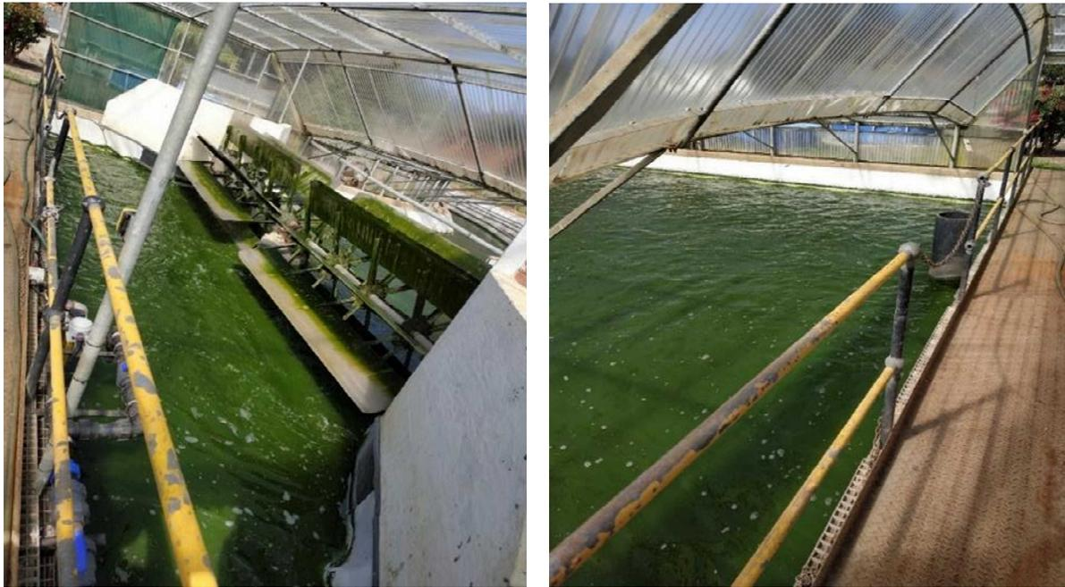
Fig.5 レースウェイ池（300,000L）での微細藻類の培養の様子
