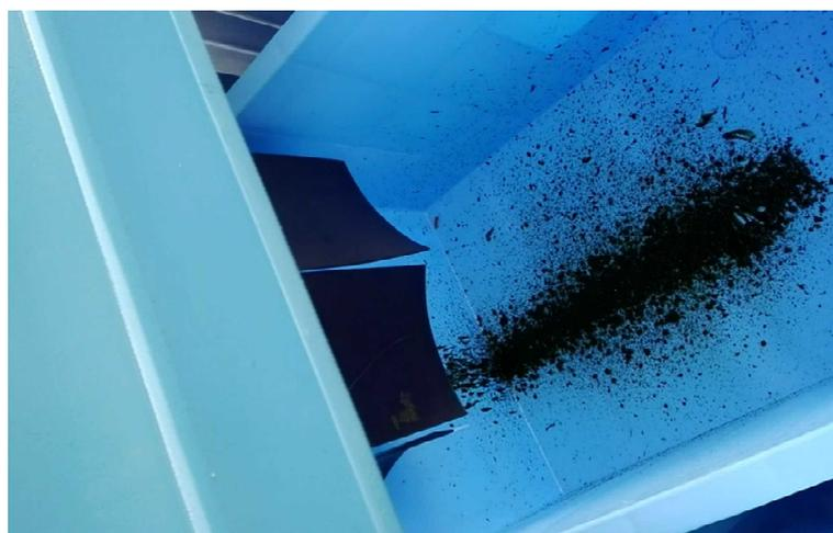
図 4-8 微細藻類回収装置で回収された微細藻類
