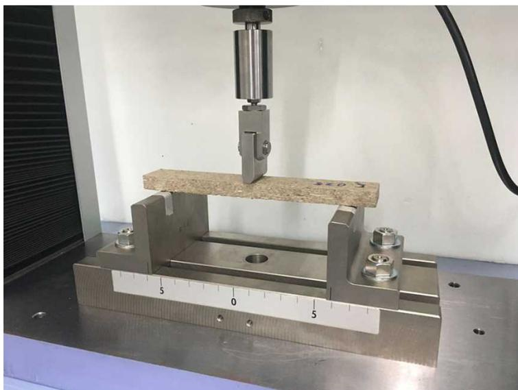
図 3-3-1 曲げ試験の構成
