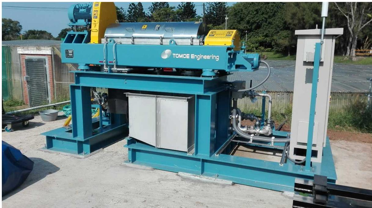
図 4-7 Kingsburgh 水処理場で稼動した微細藻類回収装置の外観
