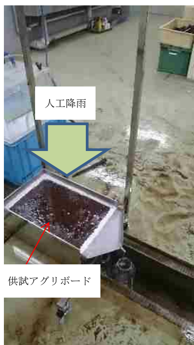
図 3-2-1 ミニ降雨シミュレーターによる揖斐森林組合のアグリボードの透水性の測定状況
