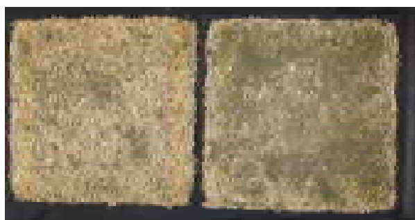
図 3.1-3 試作アグリマットの外観 200 x 200 mm (左：表 (重力方向上部) 右：裏)
