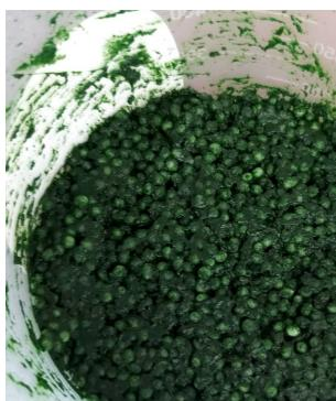
図 4-9 液化 DME 抽出前の微細藻類とセルロース球の混合物
