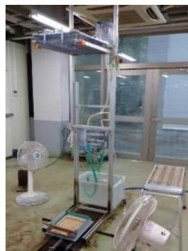
図 3.3.1 屋内用ミニ人工降雨装置
