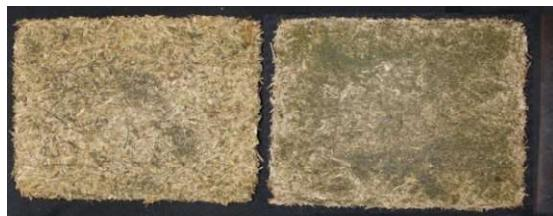
図 3.4.1 ウッドパーティクル+加熱・加圧法アグリマット外観
