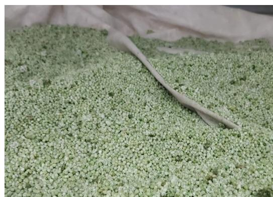
図 4-10 液化 DME 抽出後の微細藻類とセルロース球の混合残渣
