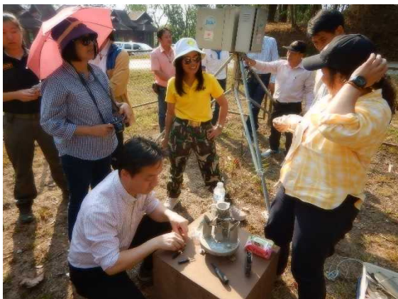
図：ナン川流域内 Doi Phuka 地点においてカウンターパートに雨量計のメンテナンス作業を指導している様子
