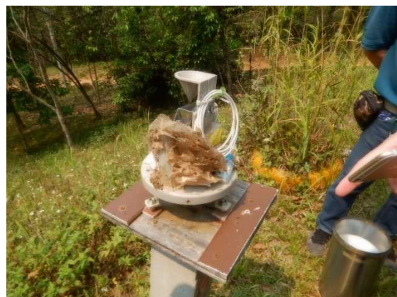
図：ナン川上流域内 Tham Sakoen 地点において、雨量計の中にアリが巣を作り計測がストップした状況
