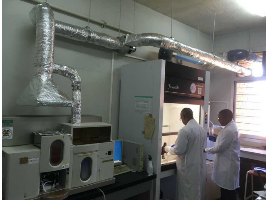
原子吸光装置（左）およびドラフト装置（右）を使用した金属分析
