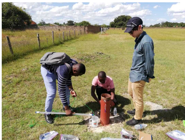
パイロット試験場脇のボーリング抗で地下水の採水
