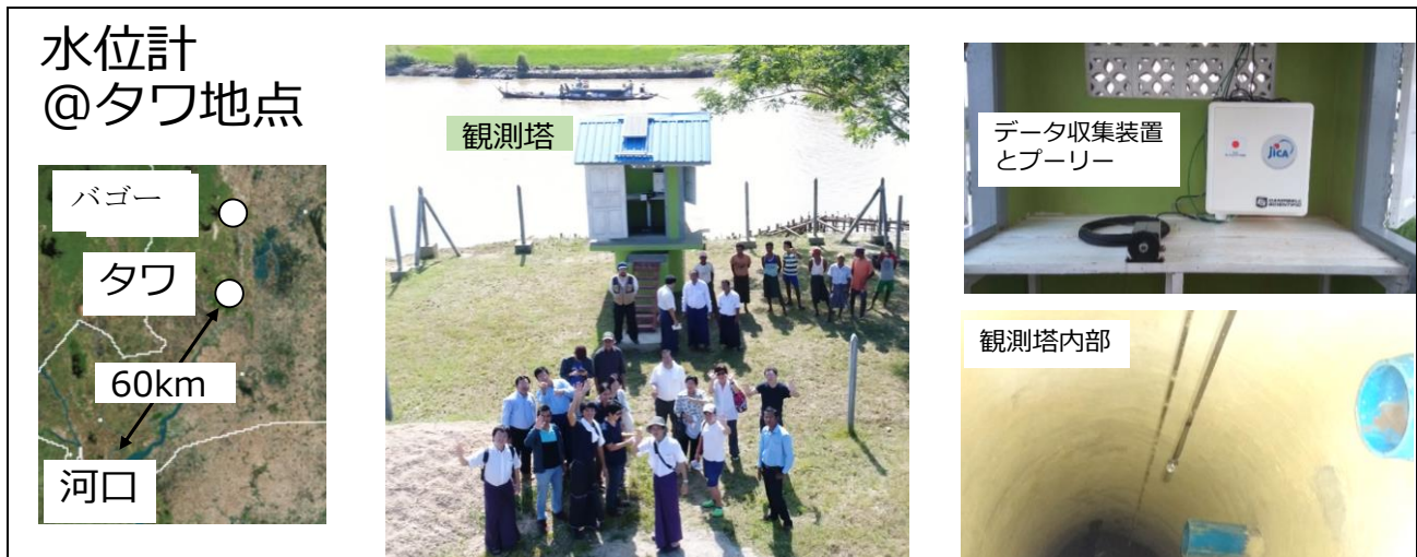
写真5 バゴー川中流のタワ・スルースゲートに自動水位観測データ収集装置を設置した
