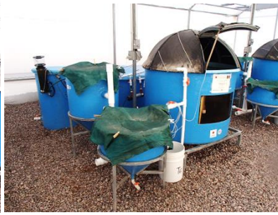
図5 CIBNOR モデルシステムの 閉鎖循環式魚類飼育装置
