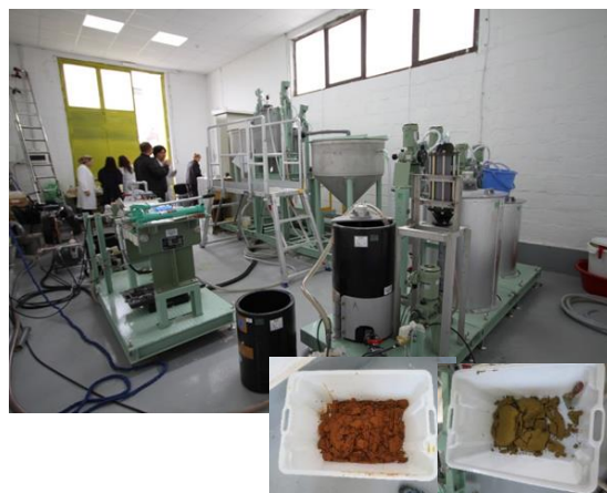
図 3. 中和沈殿法現地適用試験装置と生成沈殿物（下左：鉄主体、下右：銅主体）
