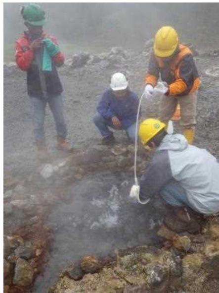
図 12 Giggenbach ボトルを用いたガスサンプリング
