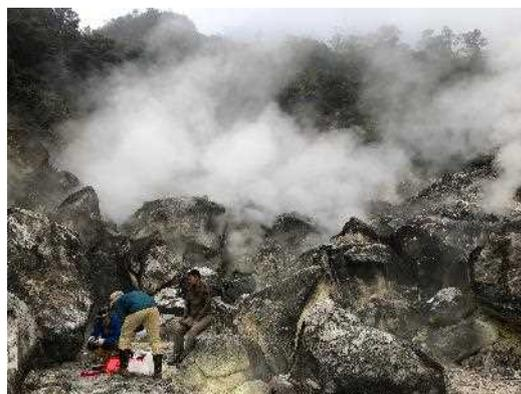
H29 年度には、Wayang Windu 地区を対象に 18 箇所の集水域から 19 個の表層水試料を採取した。試料は用途に応じてろ過を行い、密閉して保存し、日本へ持ち帰って成分分析を実施した。その結果、一部集水域より採取された表層水試料の化学成分は、他の集水域と比べて特徴的な傾向を示した。この結果を受けて、平成 30 年 7 月 13 日から 15 日にかけて、より詳細な試料の採取 (図 13)、および追加の化学分析を ITB と日本国内において実施したところ、特に試料水中に含まれる溶存無機炭素の高い含有量と低い  $\delta^{13}\text{C}$  値から、一部集水域の表層水中には地下深部起源  $\text{CO}_2$  ガスが溶け込んでいると推察された (図 14)。一方で、試料の安定酸素・水素同位体比と、金属元素濃度や Sr 同位体組成などから、一部集
