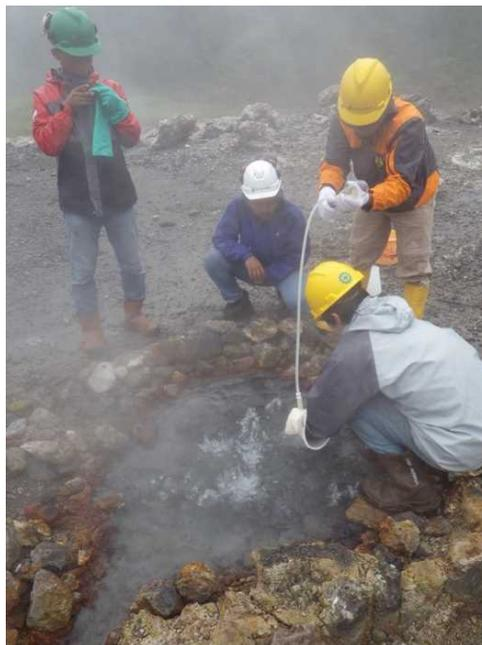
図6 Giggenbach ボトルを用いたガスサンプリング
