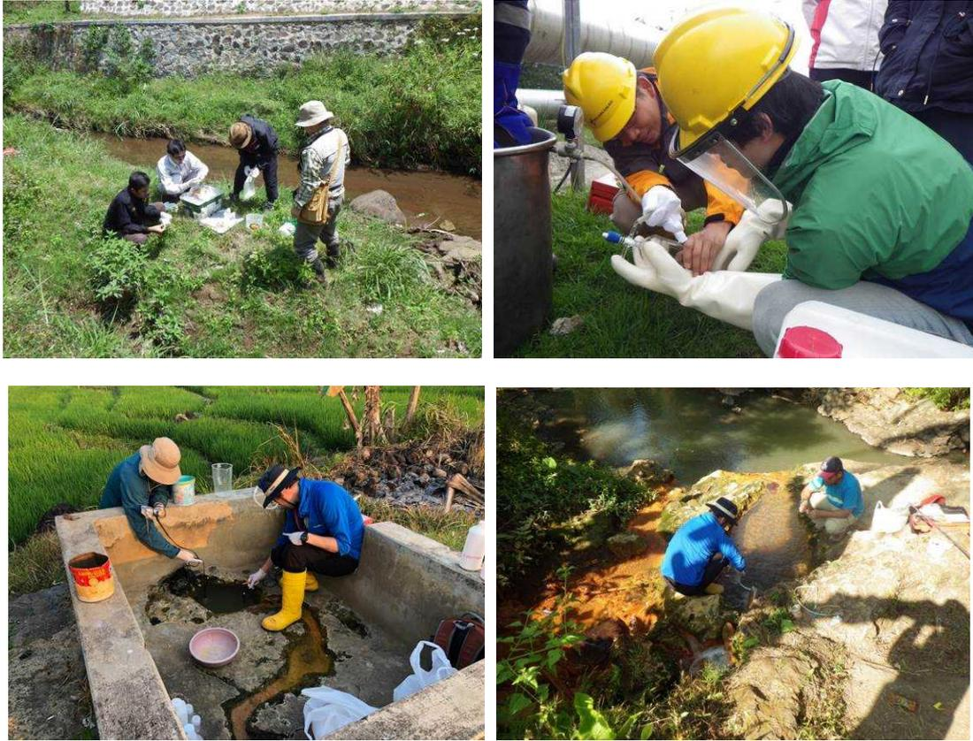
図8 野外における調査状況 (左上：表流水のサンプリング，右上：地熱生産井におけるガス試料のサンプリング，下：温泉水のサンプリング)
