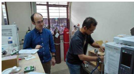
写真3 IRMS 測定用試料の調整風景。真空と高圧ガス使用の危険を伴う。
