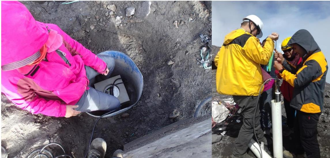
図1 スメル火山山頂における広帯域地震計（左）とボアホール傾斜計（右）の設置。
