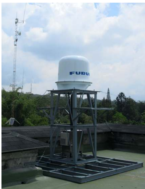
図 1-3 X バンド MP レーダー設置状況。メラピ火山南麓（左）、ケルート火山（右）。
