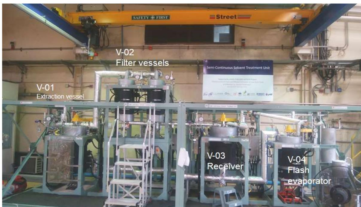
写真 4-1 半連続式溶剤改質試験装置 PTT-RTI 設置後の全景写真
