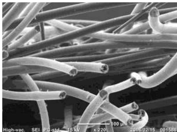
図 1-12 MM300°C-240min (m.p.= 188 °C) から調製した炭素繊維の SEM 像 (ピッチ繊維紡糸速度 = 180 m/min)
