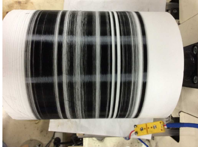
図 1-12 RS Soluble を空気中で 300℃で 85 分処理した Soluble を紡糸したピッチ繊維をロールに巻きとった様子
