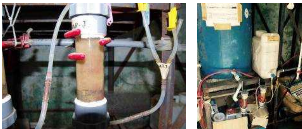
図 4.3 カトマンズ盆地の地下水から集積したアナモックス細菌とその培養装置
