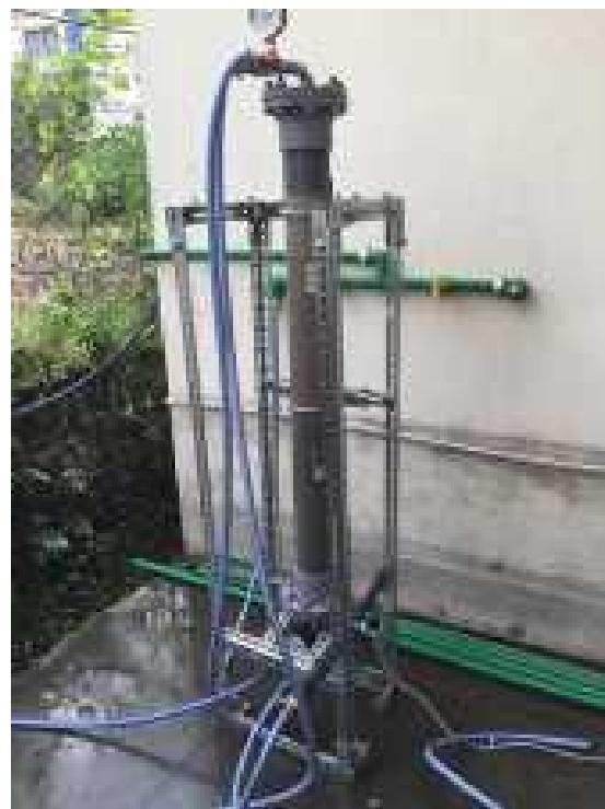
図 4.7 日本側が設置した砂ろ過装置
