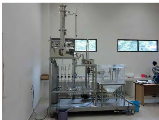
メタノール合成原料ガス前処理実験装置 (PUSPIPTEK 内に設置)
