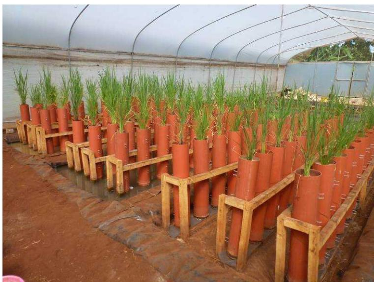
図 31 3 種類の土壌（黒綿土、赤色粘土、砂質粘土）を用いたポット試験の様子
