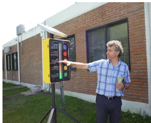
図 4. 紫外線インデックスを一般市民にわかりやすく表示する紫外線信号機(Solmaforo)。太陽電池で動き、本体に付属した紫外線センサによりリアルタイムのその場の紫外線量が表示される。
