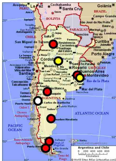
図 1. 本プロジェクトのエアロゾルライダー観測網。丸は偏光消滅観測機能有、四角は同機能無。赤はミー散乱ライダー、黄は高スペクトル分解ライダー、白はラマンライダーを表す。
