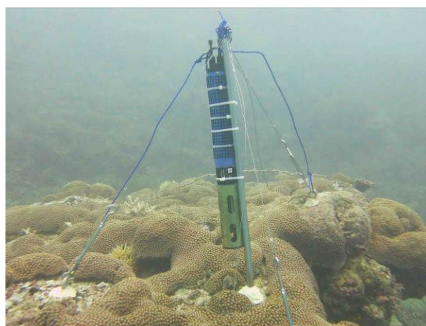
写真3 多項目センサーの設置状況
