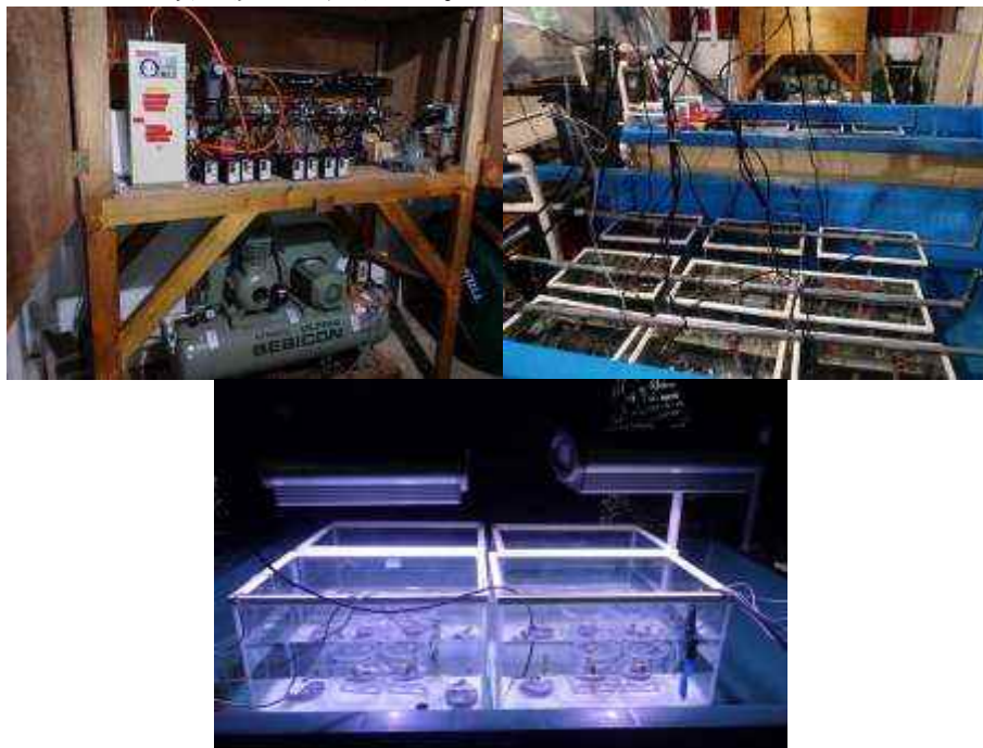
図. PICRC に設置された酸性化実験装置。上左図：CO2 制御装置、上右図：屋外での酸性化、温暖化水槽実験の様子、下図：屋内でのサンゴ代謝実験の様子
