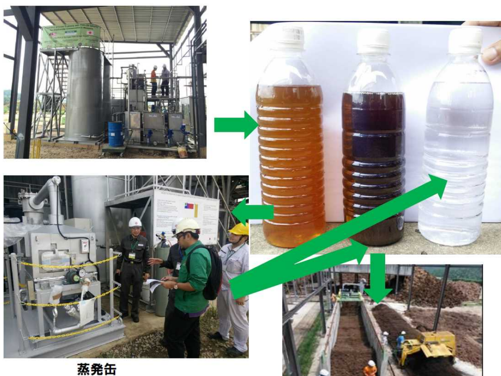
図 4 . POME 最終処理液の蒸発缶による清澄化
