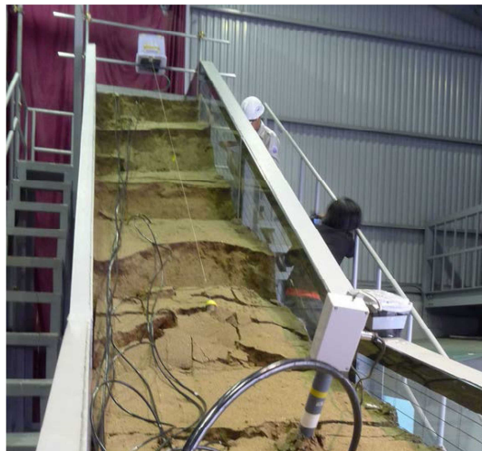
図5 ITSTに整備された斜面崩壊実験用の建屋(左)、斜面(中)および開発された多層型土壌水分計(右)
