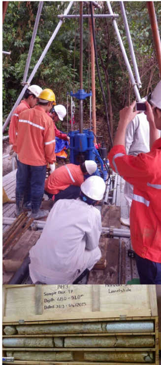
図3 ハイバン地すべりにおけるボーリング技術移転と想定とすべり面の51m付近のコア
