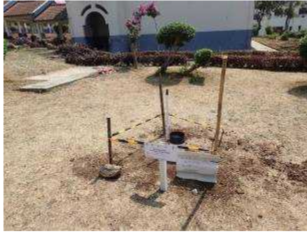
Fig. I-2-(2)-2 降雨計・土壌水分計の設置（平成 27 年 9 月、ITB Jatinangor キャンパス）
