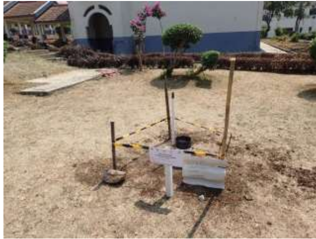
Fig. I-2-(2)-9-2 降雨計・土壌水分計の設置(平成 27 年 9 月、ITB Jatiningor キャンパス)
