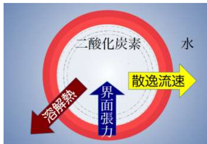
Fig. I-2-(5)-10 CO 2 と水の溶解と熱の関係の模式図
