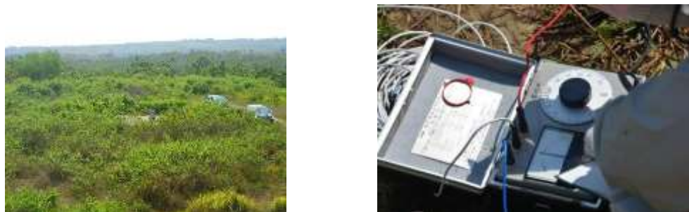
Fig. I-2-(3)-5 予察の様子(左:Jepon-1 周辺、右:送信電極設置候補地での接地抵抗測定)
