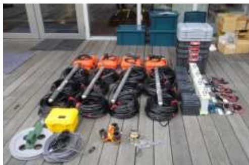
Fig. I-2-(4)-6 平成 24 年度に導入した微小地震観測システム（4 式）
