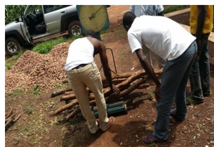
写真 3-1 木質燃料の計測
