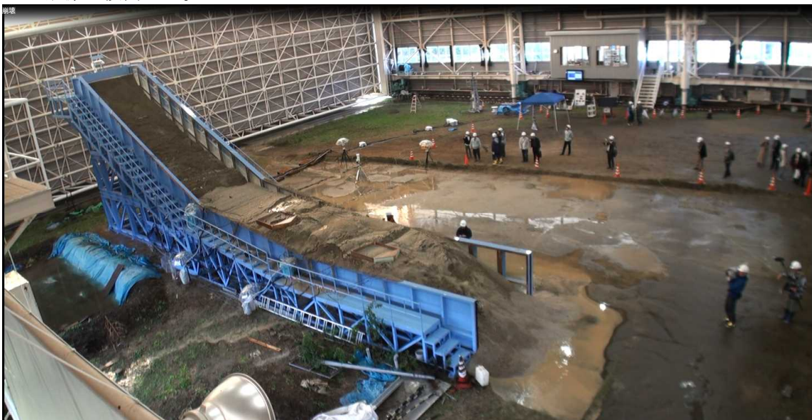
図 2-(4)-4 防災科学技術研究所で行われた大型斜面崩壊実験（2014 年 10 月）
