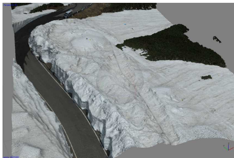
図 2-(2)-4. 低温・高標高条件下での UAV-SfM 性能試験結果（乗鞍岳）
