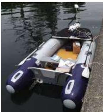
図28a 近接ボートから遠隔操作可能なボート
