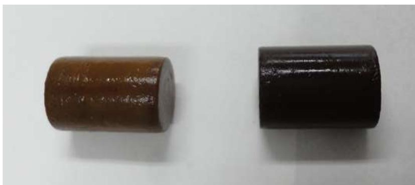
図18. ニオス湖水(深度200m)と3カ月間反応したセメントコア
