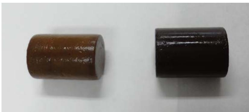
Fig. 4 ニオス湖水（深度 200m）と 3 か月間反応したセメントコア
