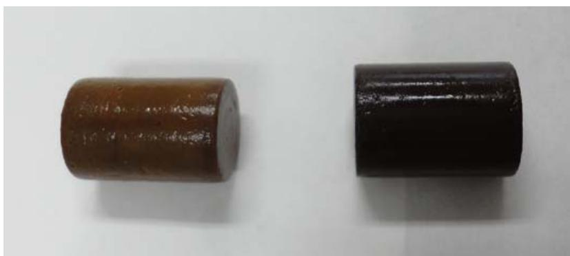
Fig.6 ニオス湖水(深度200m)と3カ月間反応したセメントコア
