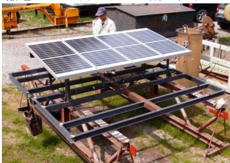
図 1-8. 深層水汲み上げ装置の仮組立と試運転 (ソーラーパネルの右の円筒タンク内に水中ポンプを入れて試験を行った 2013 年 7 月)
