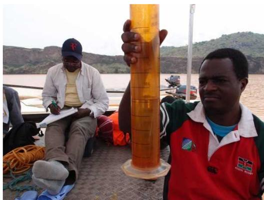
図 1-12. メスシリンダーでセパレーター内の水の体積を測る．後方では各種データをパソコン入力用シートに記録している．
