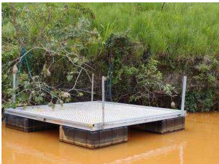
図1-15. ニオス湖の観測作業筏 (3.2m×3.2m)
