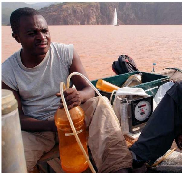
図1-11. セパレーターで水とガスに分離する(右後方はガス流量計)。
