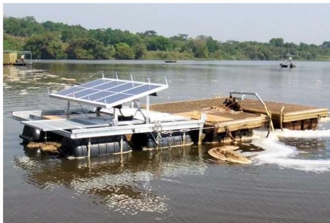
図 1-9. 深層水汲み上げ装置の設置直後の状況（マヌン湖 2013 年 12 月 13 日）
