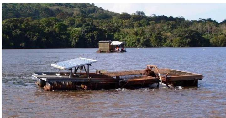
図 1-10. 設置から 2 年後の深層水汲み上げ装置の状況（2015 年 11 月 7 日）
