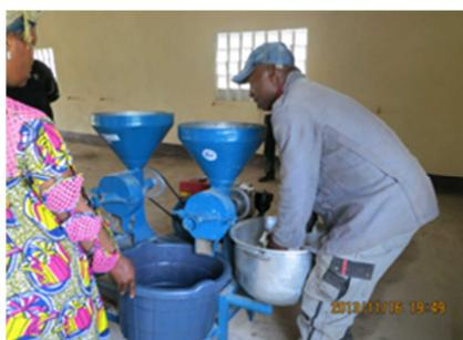
写真 1. キャッサババトン製造機
