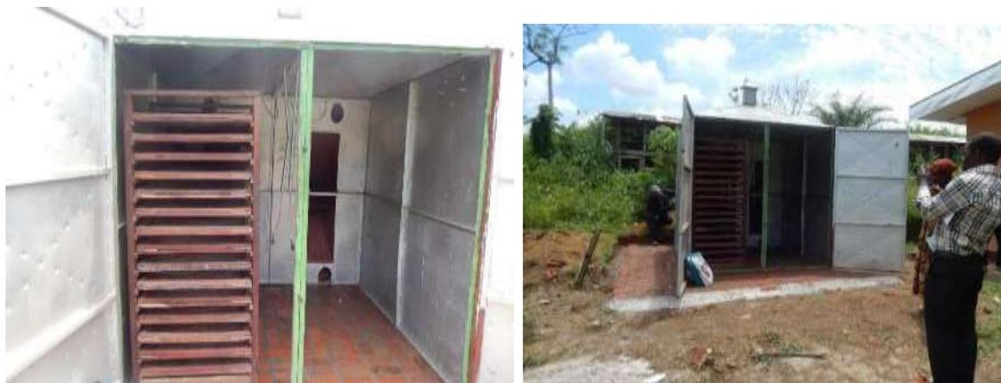
写真 1.11 Bitiyili 村に設置されたキャッサバ通風乾燥機
